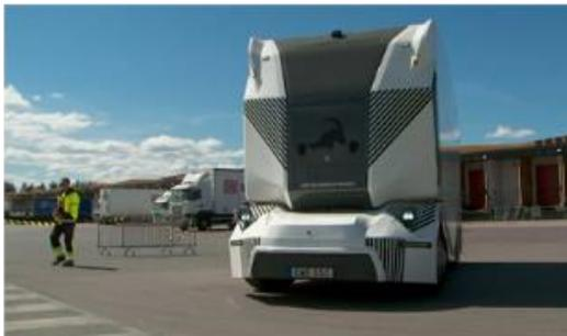
スウェーデンのスタートアップ企業はt-podモデルという26トンのEVトラックで運輸サービスを開始。運転手付きのディーセルトラックの利用と比べ、物流コストが60%削減できた
